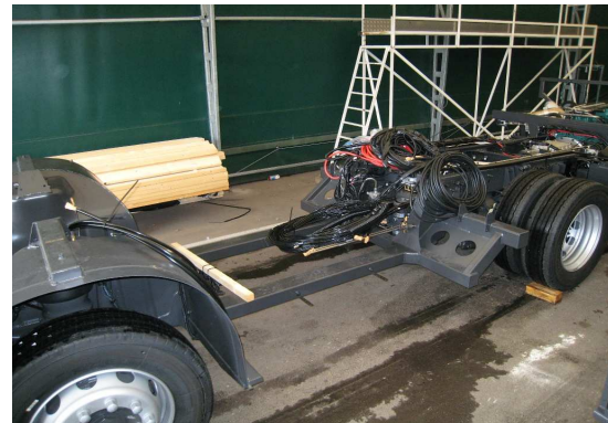
Exempel på suboptimering – förkortad hjulbas.
